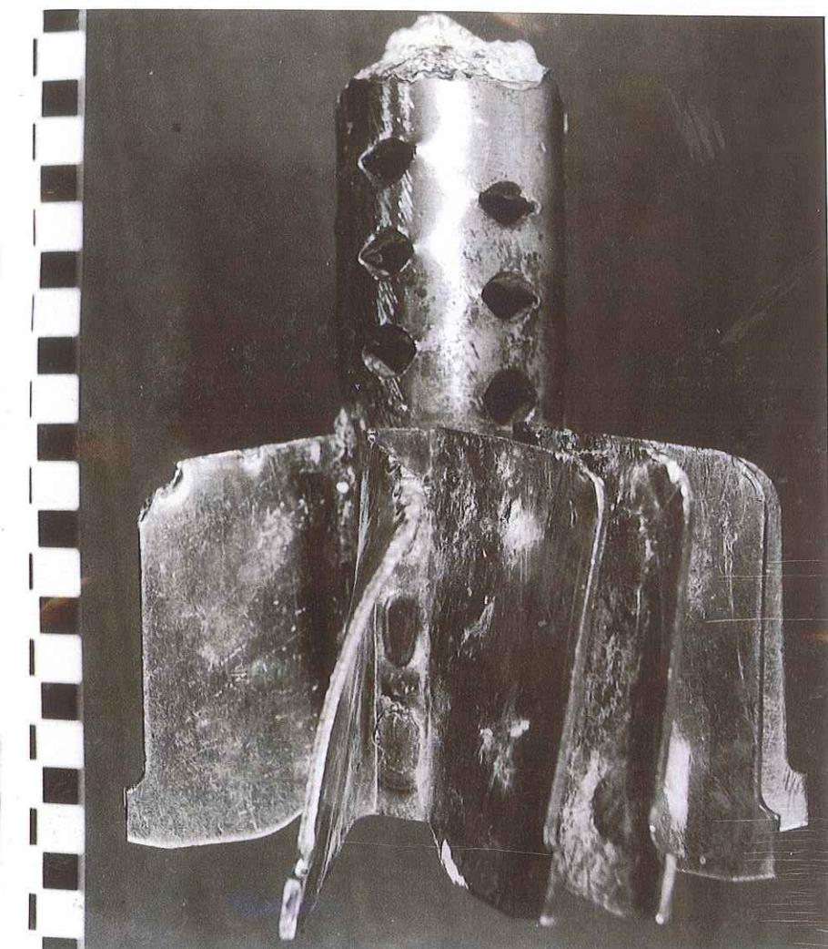
Stabilizator minobacačkog projektila cal. 120 mm fotografisan uz razmjernik.
