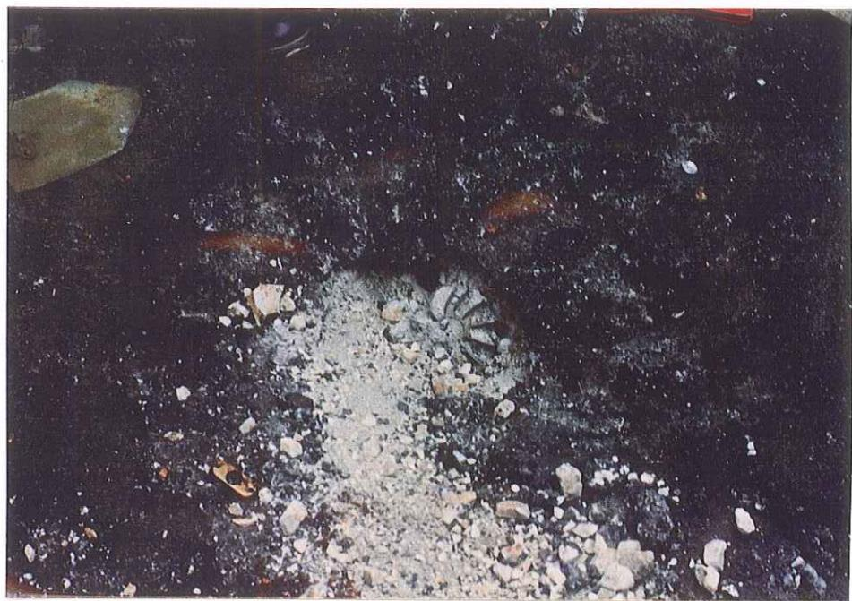
Nakon čišćenja površinskog sloja materijala na mjestu pada minobacačkog projektila pronađen je stabilizator minobacačkog projektila cal.120 mm.
